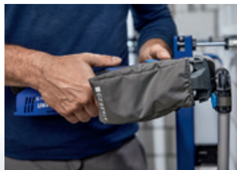
Bij het persen met de opvangvoorziening worden de persindicatoren direct verzameld en kunnen ze in de verzamelbak worden afgevoerd.
