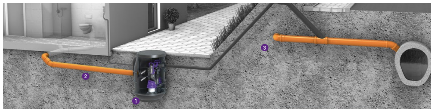
1 Pompstation 2 Wateraanvoer 3 Persleiding
