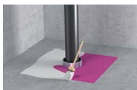
4. Breng Tangit FP 800 Brandwerende Coating aan op het schuim met een overlap van 3 cm op de vloer / het plafond
