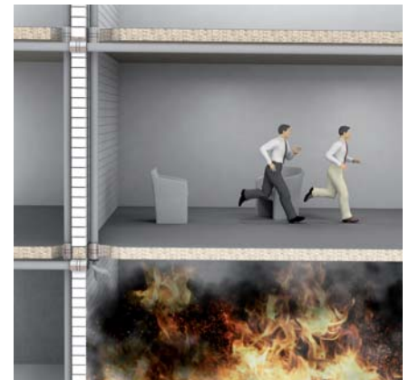
3. De BIS Pacifyre® MK II Brandmanchet wordt geactiveerd en de aanwezigen hebben tijd om te vluchten
