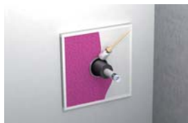
4. Breng Tangit FP 800 Brandwerende Coating aan op het schuim met een overlap van 3 cm op de wand
